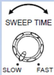
Ruotando la manopola SWEEP TIME è possibile regolare il tempo di sweep da 1 a 30 secondi
