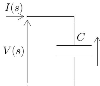
L'energia accumulata nel sistema è:  $E(t) = \frac{1}{2} C V^2(t)$ . Tale energia varia nel tempo solo se è presente un flusso di potenza  $p(t) = \dot{E}(t) = V(t) I(t)$  in ingresso al sistema. Da un punto di vista *matematico* il sistema può essere orientato in due modi diversi:
