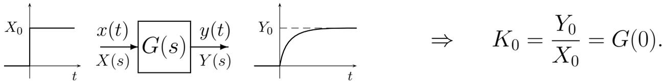
Utilizzando il criterio del valore finale è facile dimostrare che il guadagno statico  $K_0$  di un sistema  $G(s)$  coincide con  $G(0) = G(s)|_{s=0}$ , cioè con il valore della funzione  $G(s)$  per  $s = 0$ :
